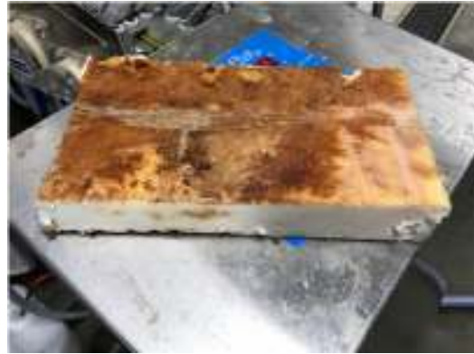
変色した断熱材②
